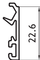
Tapajuntas Ventana Corrediza a 90° 0,160kg/m 06413 Barras de 6.05m
